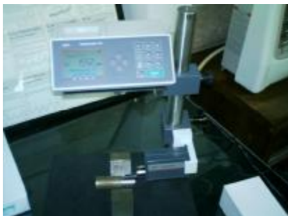
شکل ۳: نمایی از دستگاه زبری سنج و نحوه اندازه گیری زبری قطعه کار.
